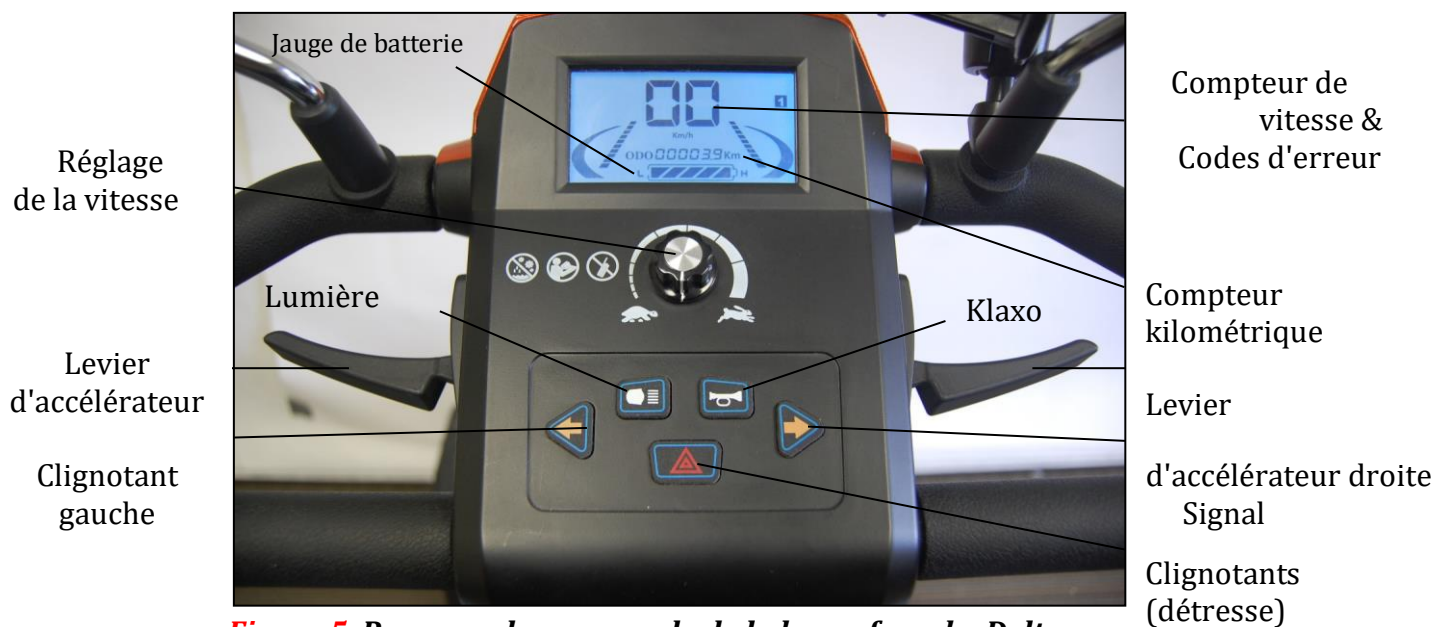
Figure 5. Panneau de commande de la barre franche Delta avec écran LCD
