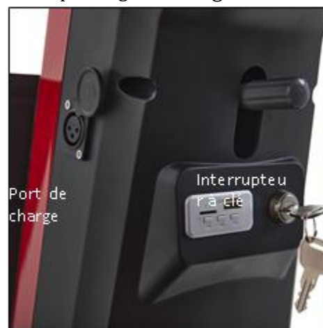
Figure 19. Chargement des batteries
