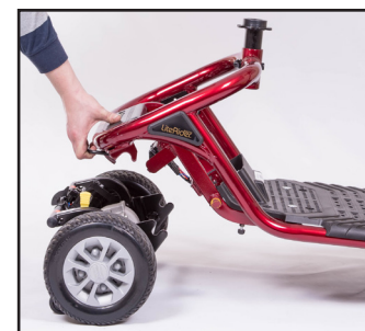
Tout en pressant le levier de déverrouillage, tirez le cadre arrière vers le haut
