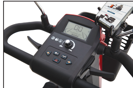
L'écran LCD intégré de la console permet de surveiller la vitesse, le kilométrage, les codes de défaut et l'autonomie de la batterie.
