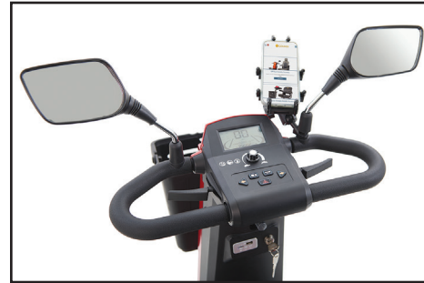
Rétroviseurs, support pour téléphone portable et système de haut-parleurs intégré avec connectivité Bluetooth® et USB.
